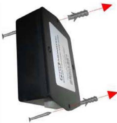
El tamaño reducido del equipo permite ser instalado dentro de la misma central de alarmas, siempre y cuando haya espacio suficiente, y el nivel de señal sea bueno. Esto evita el cableado externo a la unidad, y evita tener que asegurar el lugar de instalación con sensores adicionales, ya que se asume que la central está en un lugar asegurado.
