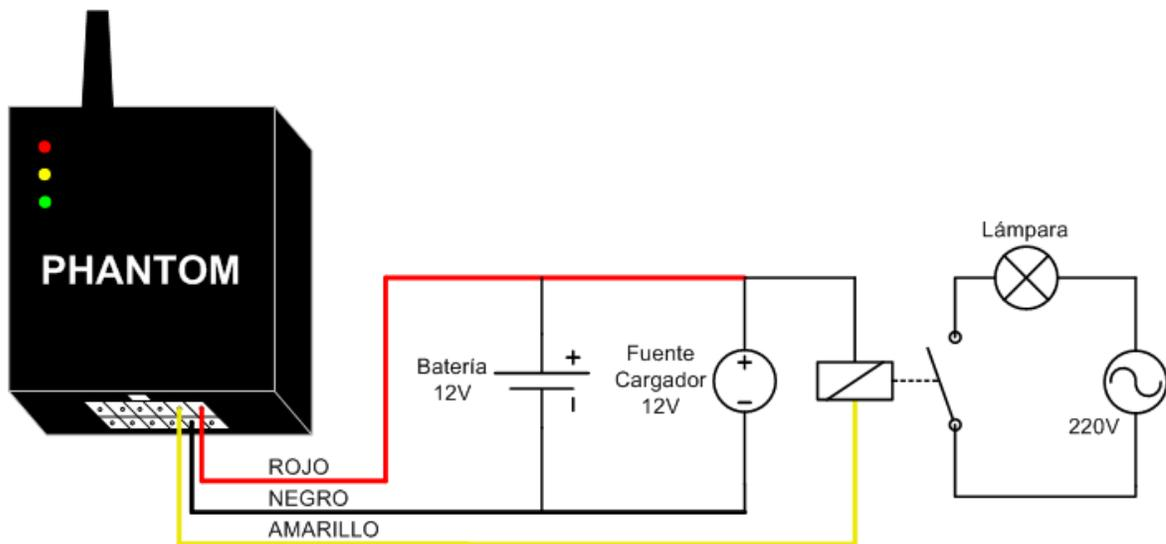
Además, ambas salidas pueden configurarse en modo especial, para que reflejen el estado de la línea telefónica (salida 1), activando la salida si la línea está en falla, o el estado de la conexión a la red celular (salida 2), activándose cuando se pierda la conexión a la red.
