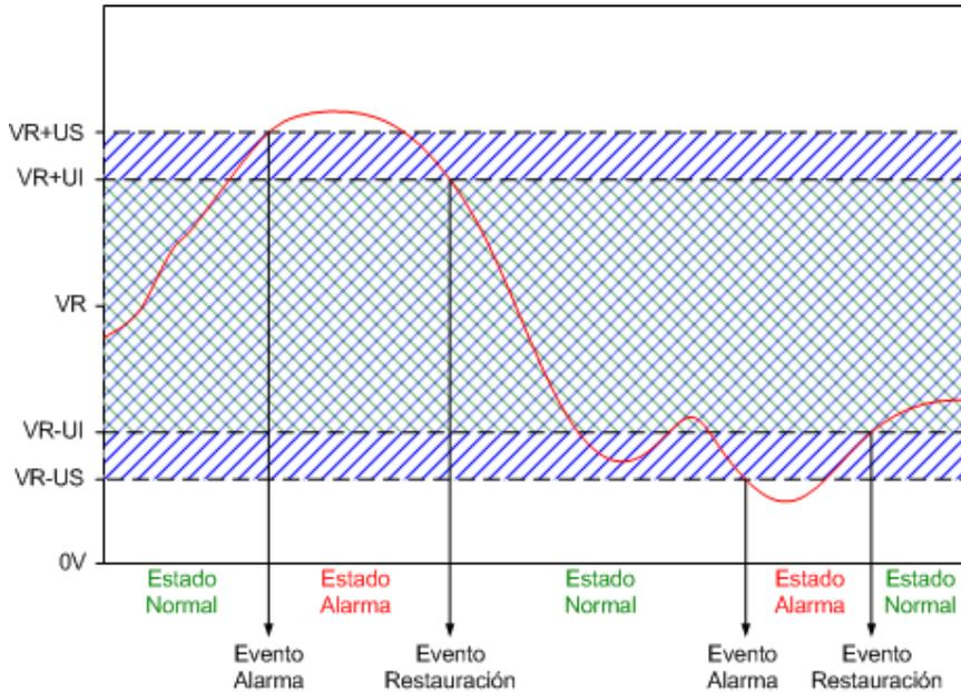
El equipo viene configurado de fábrica con los siguientes valores: VR = 0V, US = 2V, UI = 1V, permitiendo por ejemplo la conexión de un relé o pulsador normal cerrado, con una resistencia pullup a +12V para detectar el cambio de estado cuando pasa a abierto. A continuación se muestra el mencionado ejemplo:
