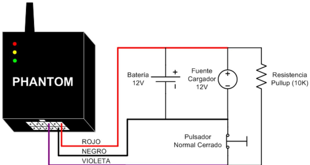
El esquema propuesto utiliza un simple pulsador cableado, que podría reemplazarse por uno inalámbrico, conectando la salida a relé del receptor inalámbrico en lugar del pulsador cableado.
